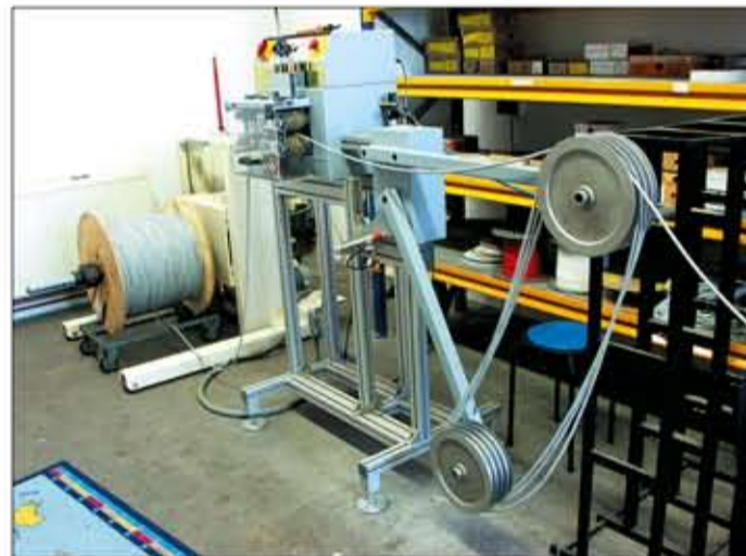
Mit Hilfe dieser Maschine können Kabel auf den Millimeter genau zugeschnitten werden.
