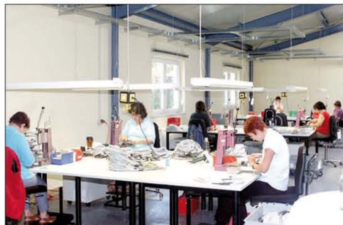
In der neuen Produktionshalle werden die vorbereiteten Kabel mit den passenden Steckern bestückt.
